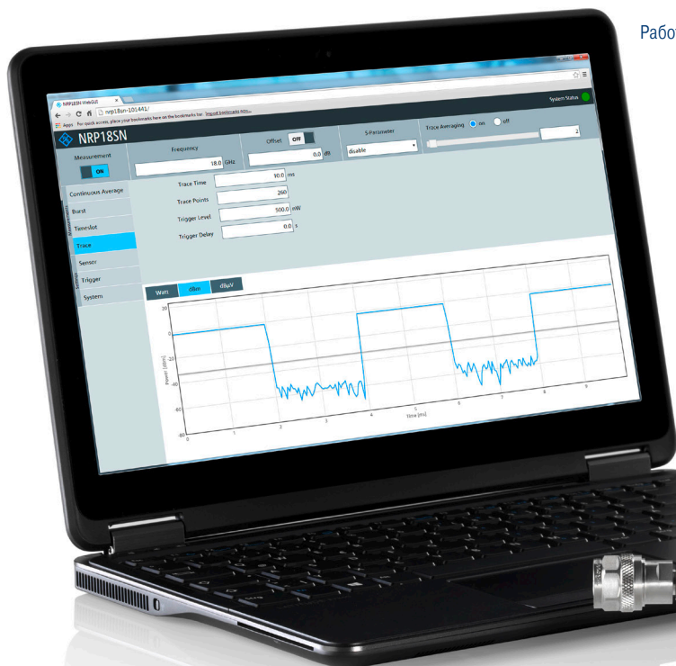
Сетевой интерфейс, вход/выход запуска и отсоединяемый кабель для датчиков R&S®NRPxxSN
